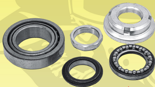
K640 Tazas de direccion Para DS125, DS150, GS150, GTS175, XV150 CARABELA (MARCA KMOTO)
