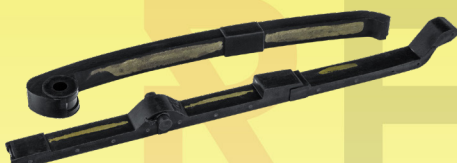
REM3904 Guías de cadena de distribución Para 170Z 16-18 - 250SZ 23 - 250Z 14-23 - 250Z NEGRA 17-19
